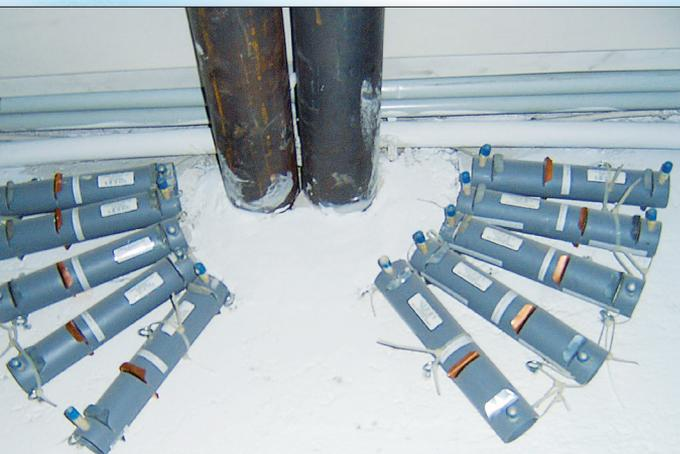
Abbildung 8: Zehn (kleine) MHR der alten Version auf eine 110-KV-Leitung unter der Erde in der Münchener Innenstadt gerichtet.
