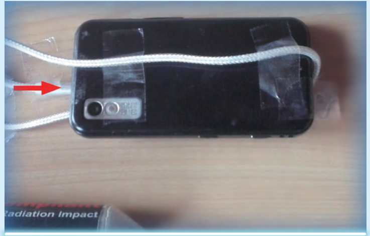
Abb. 5: SHLS-Prototyp (links unten als kleiner Ausschnitt zu erkennen) mit galvanisch leitender Direktverbindung zu einem 4G/LTE-tauglichen Smartphone. Der rote Pfeil markiert den Einsteckpunkt über die Handy-Headset-Buchse gemäß Abb. 1.
