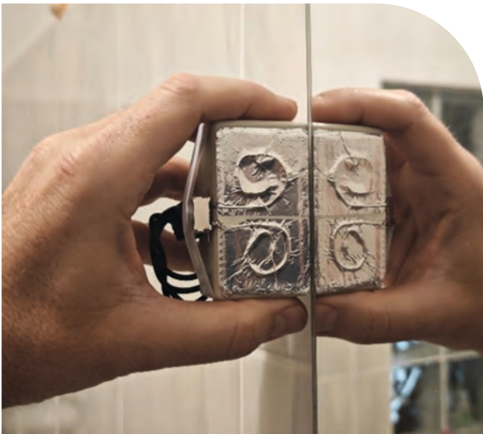
Abb. 3: Ein Prototypen-SHLS für den Spiegeleinsatz mit leitender Fläche (Draht darunter an zwei Polen gewickelt und in ein SHLS eingekoppelt). Er wird parallel zur metallisierten Spiegelfläche als Ankopplungs-/Wechselwirkmedium angebracht. Dieses Spiegel-SHLS-Kästchen ist hier um 90 Grad zur Fotofläche gedreht gezeigt, was sonst parallel auf den Spiegel fix angebracht wird.
