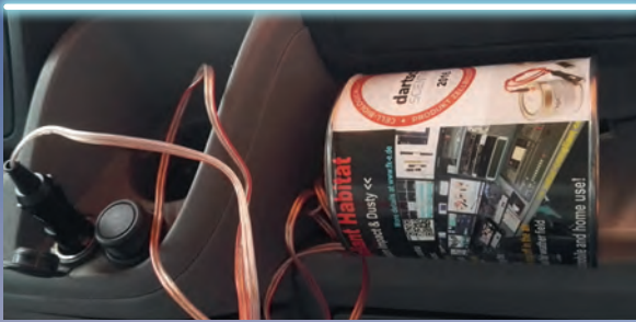
Abb. 2: Hier ein Beispiel, wie ein Handwerker improvisierend in einem Transporter (<7,5 t Sprinter) die größere Pkw-MHR-Dose einfach in die Front-Konsole gelegt hat. Man sieht auch sehr gut, dass nur ein Cinch-Stecker-Verbindungskabel die Dose mit der PKW-Zigarettenanzünder-Buchse (12V) verbindet.
